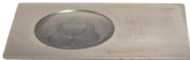
Рис. 2. Стандартный держатель, поставляемый с дифрактометром XRD-6000.
